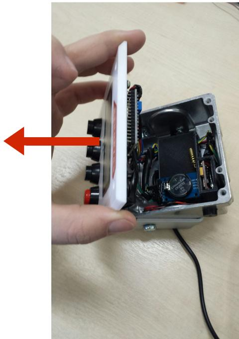
PODE VIRAR A TAMPA ATE ENCOSTA-LA NA MESA, APOIANDO-A PARA FACILITAR O MANUSEIO. EM SEGUIDA, INSIRA O CHIP NO LOCAL INDICADO NA IMAGEM A SEGUIR, CONFORME INDICADO, NOTE A POSIÇÃO DO CHANFRO DO CHIP, VOLTADO PARA BAIXO E A PARTE DE CONTATOS DO CHIP VOLTADO PARA O LADO DA PILHA DO RELOGIO.
