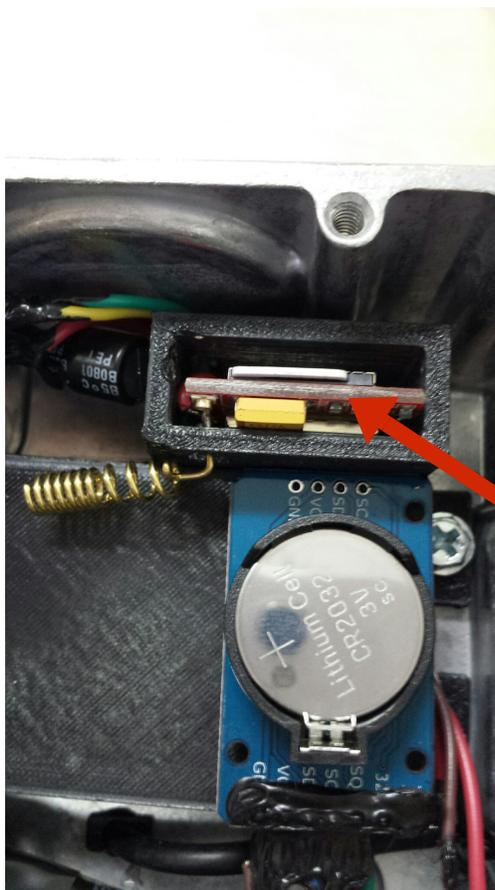
O CHIP DEVE SER INSERIDO ATE O FIM CONFORME A ULTIMA FIGURA ACIMA E A DIREITA.
